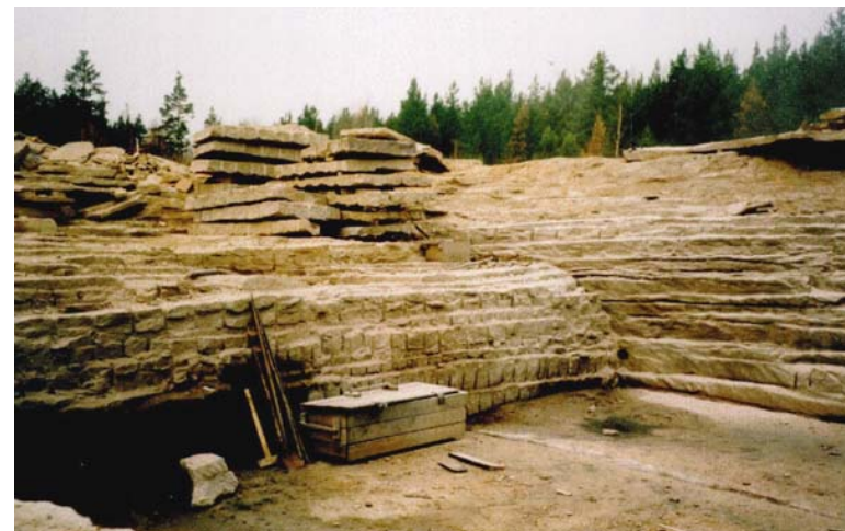
Рис. 3. Опытный карьер. Переход от зоны камня-плитняка к блочным гранитам.
