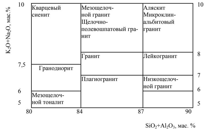
Рис. 13а. Фрагмент рис.13, уточняющий классификацию мезощелочных гранитоидов.
