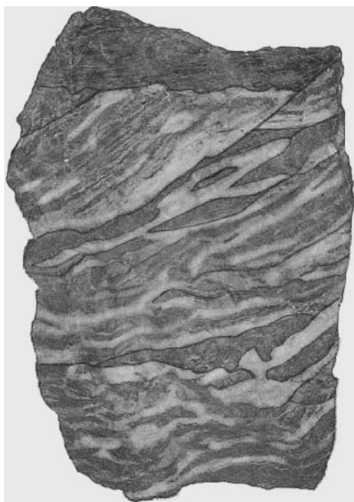
Рис. 2. Косослоистая текстура в слабо известковистом песчанике. Косые борнит-халькозиновые слойки (темное), развиваемые по кливажной трещиноватости с заметным метасоматическим замещением. Отчетливое обогащение рудным веществом в отслоениях. Отдельные ретушированные детали. Размер образца 0,9 × 0,5 м (штольня № 2).
