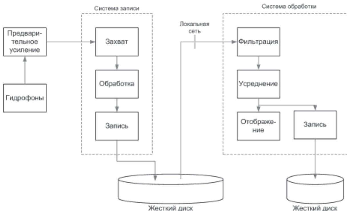
Рис. 1. Общая схема измерительного комплекса.
