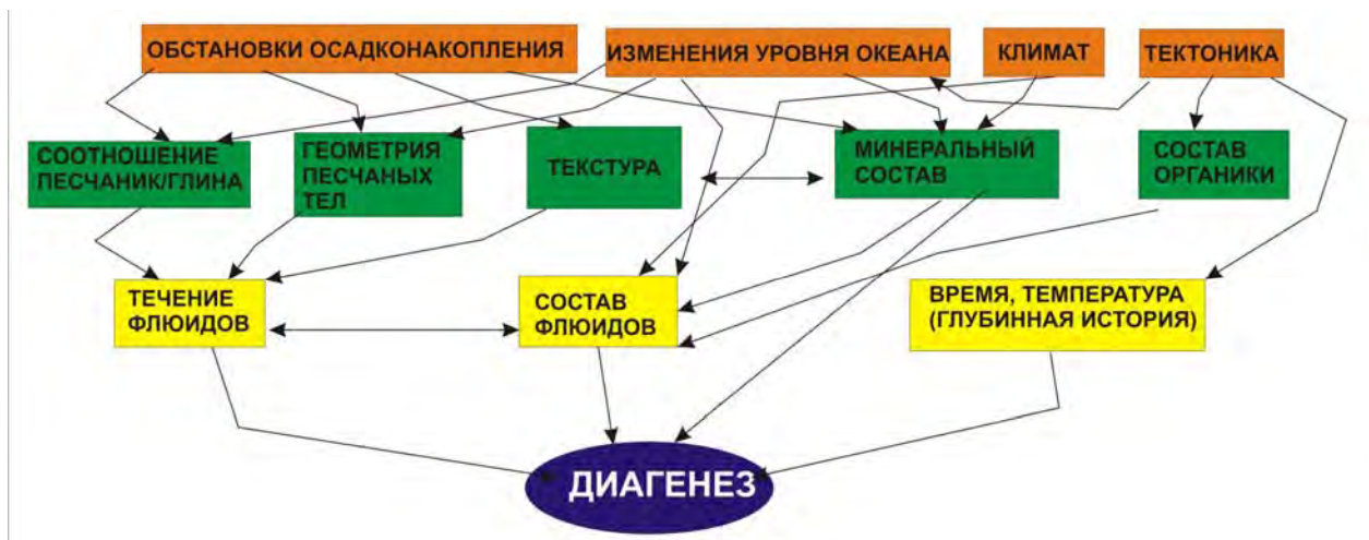
Рис.1.2.2. Иллюстрация взаимоотношений между разными факторами, влияющими на постседиментационные преобразования осадочных пород (по Stonecipher et al., 1984; Mansurbeg, 2007)
