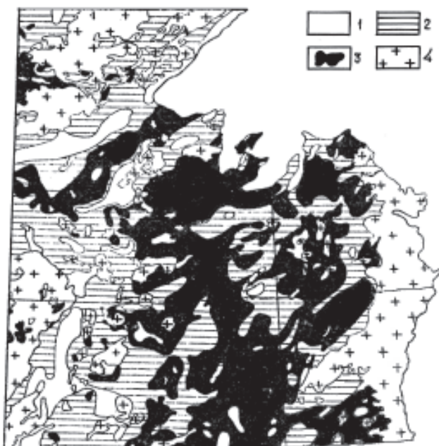
Рис. 7. Схема напряженности складчатых деформаций в структурах Дальнего Востока. 1-3 – поля напряженности складчатых деформаций: 1 – углы наклона крыльев складок от 0 до 30°, 2 – 30-70°, 3 – более 70°; 4 – площадь, занятая разновозрастными магматическими образованиями.
