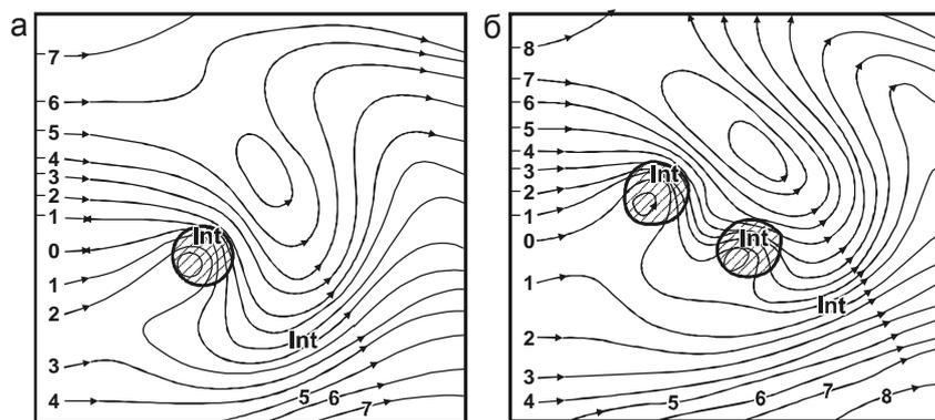
**Рис. 3.** Обтекание одиночных (а) и двойных (б) цилиндрических возмущений рельефа дна (заштриховано) в гиперболически стратифицированном океане восточным потоком в северном полушарии (int – зоны интенсификации течений) [6].
