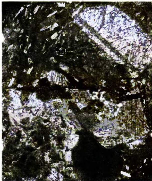
Фиг. 5. Кучное расположение и зональное строение пироксенов в бомбе (Шлиф 298, увел. в 45 раз, + николи).
