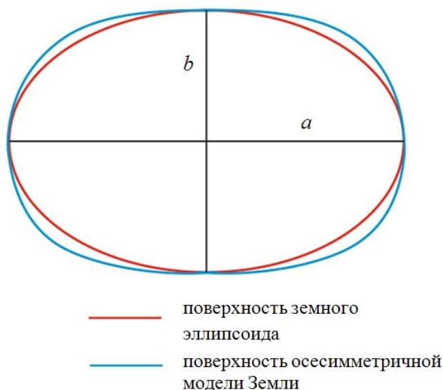
Рис. 2. Взаимное расположение поверхностей земного эллипсоида и осесимметричной модели Земли
