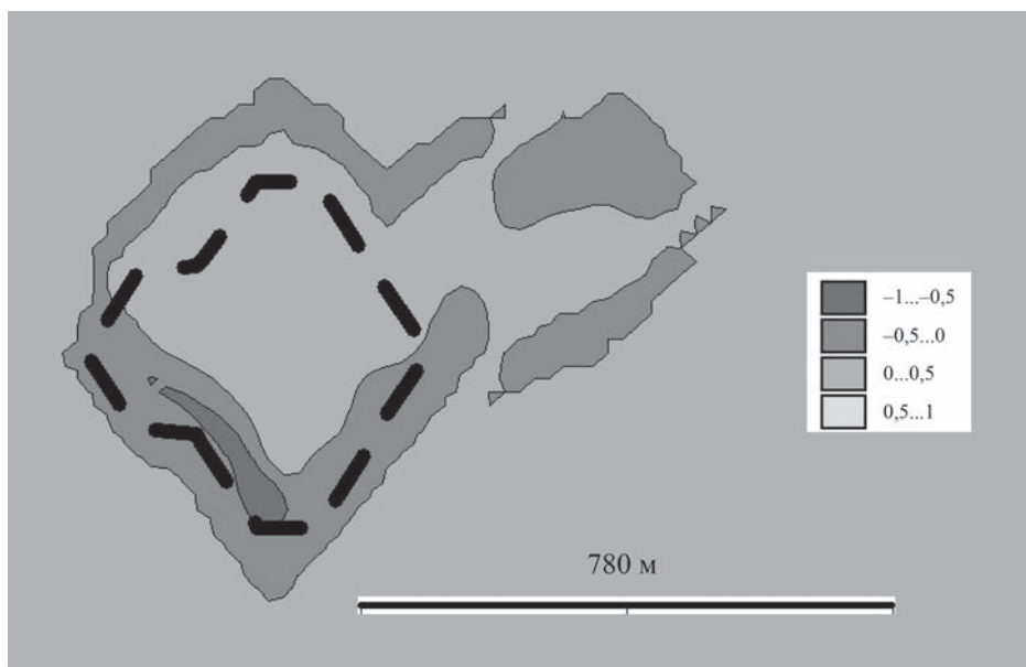
Рис. 7. Интегральные наносы и размывы, см, за год в акватории предполагаемого временного причала у о. Тузла, пунктирной линией отмечена граница дноуглубления
