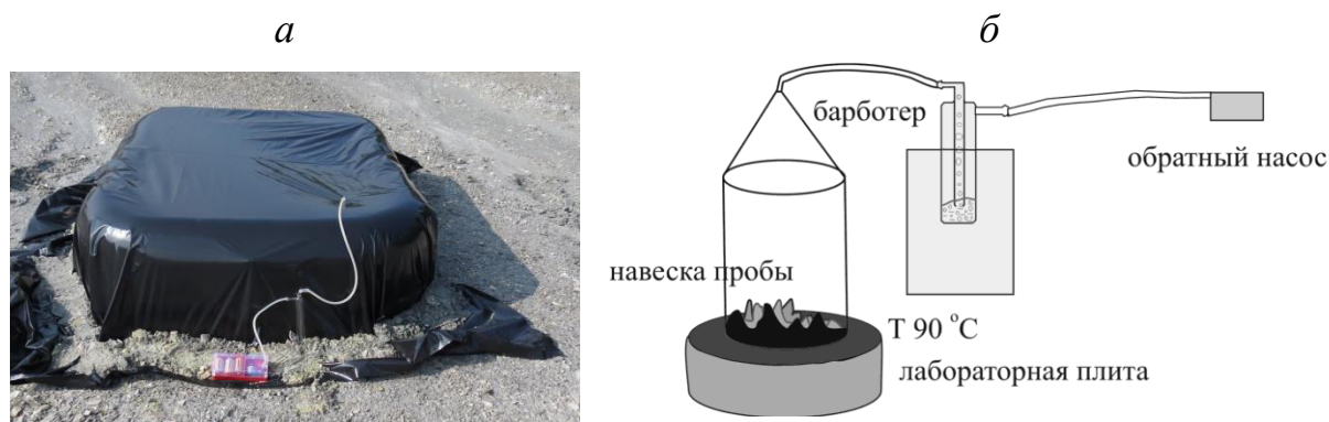
Рис. 1. Схемы полевых и лабораторных экспериментов: прокачка через щелочную загрузку (а); нагревание и получение конденсатов в лабораторных условиях (б)
