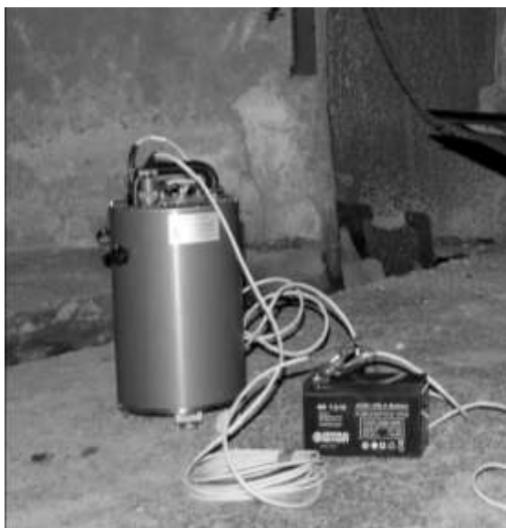
Рис. 2. Широкополосная трехкомпонентная сейсмическая станция Guralp CMG-3ESPCDE, установленная на одном из пунктов профиля
