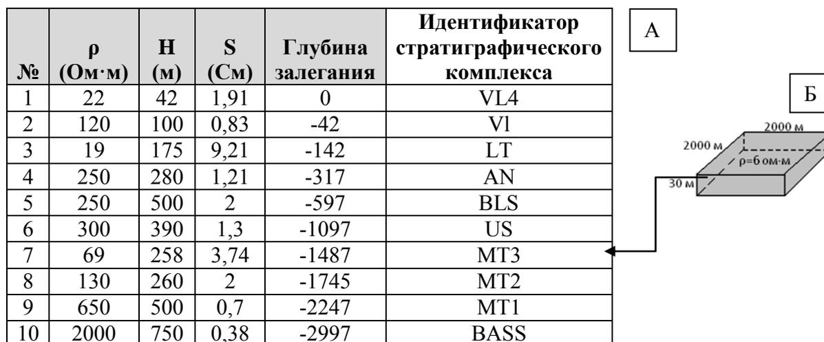
Рис. 2. Параметры геоэлектрической модели: А – типичная геоэлектрическая модель для юга Сибирской платформы; Б – трехмерный объект
