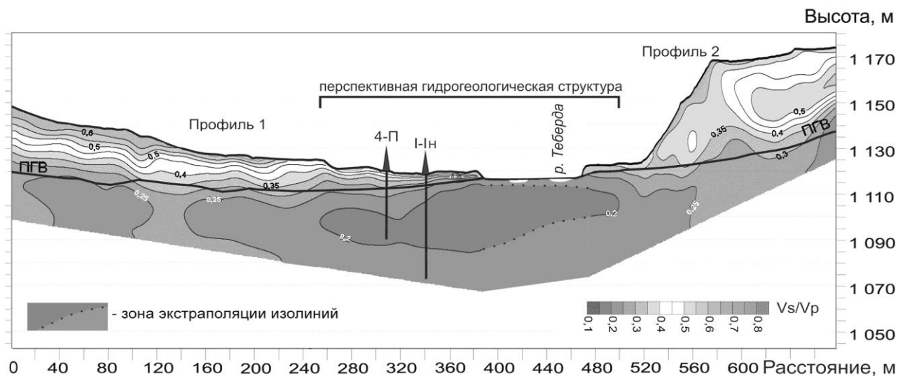
Рис. 3. Сводный томографический разрез по параметру V_s/V_p по профилям 1 и 2. Верхнетебердинский участок
