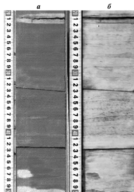
Рис. 1. Фото керн доломитизированной кремнисто-радиоляритовой породы при дневном (а) и ультрафиолетовом (б) освещении
