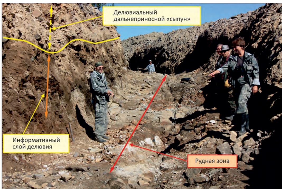
Рис. 11. Рудная зона, вскрытая канавой под слоем дальнепринесенного делювия
