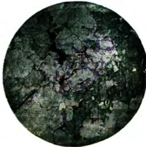
Фиг. 33. Зернистая вулканическая порода (эксплозивный обломок). Видны кристаллы лабрадора, клинопироксена и магнетита, склеенные стеклом. Без анализатора; \times 19 .
