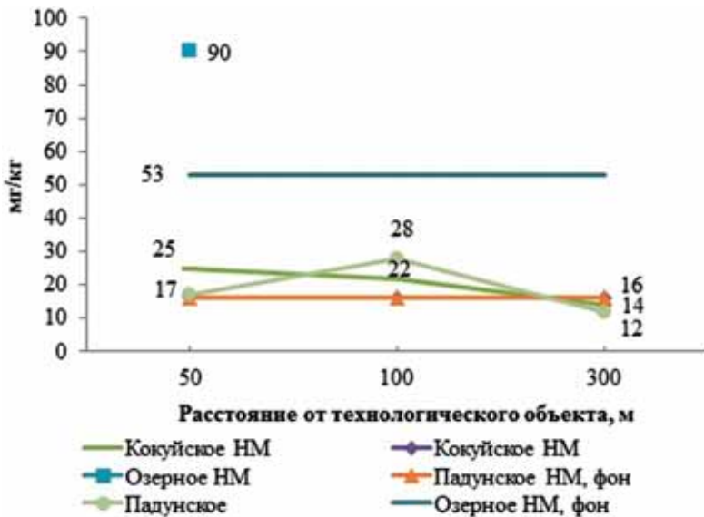
Рис. 6. Средние концентрации хлоридов вблизи основных типов технологических объектов нефтяных месторождений
