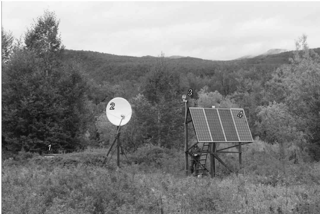
Рис. 6. Специализированный пункт наблюдений за вулканической деятельностью TUMD 1 – сейсмокамера; 2 – оборудование технологической связи VSAT; 3 – IP-видеокамера; 4 – система автономного питания на солнечных панелях
