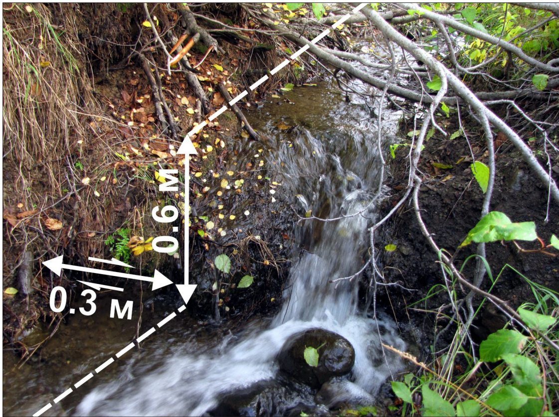
Рис. 4. Вертикальное (0.6 м) и горизонтальное (0.3 м) смещения, измеренные по водопаду, образовавшемуся в результате пересечения ручья сейсморазрывом 2006 г. Фото сделано в т.н. 506 (таблица), в ~200 м восточнее т.н. 022 (рис. 2).
