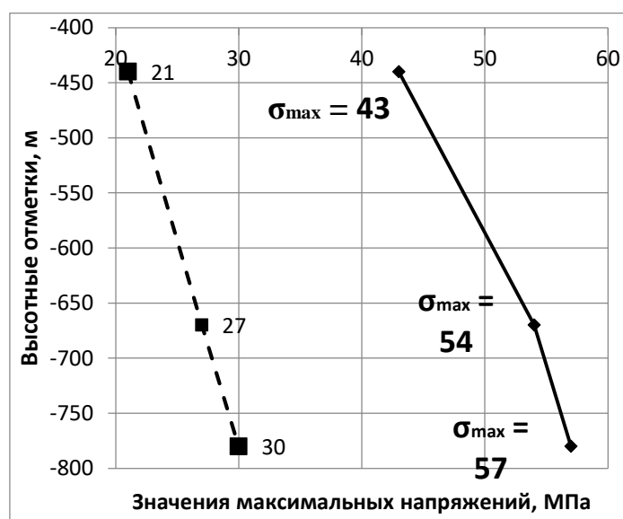
Рис. 2. Зависимость максимальных напряжений \sigma_{\max} от глубины
