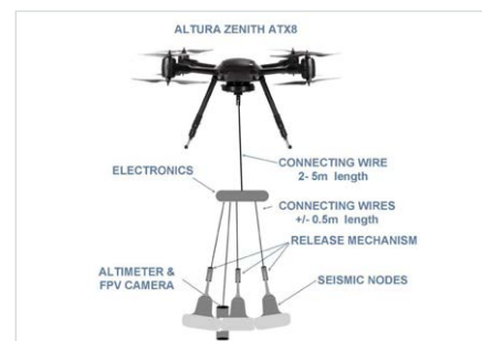
Рис. 4 — Дрон с группой сейсμοприемников, готовый к полету на профиль
