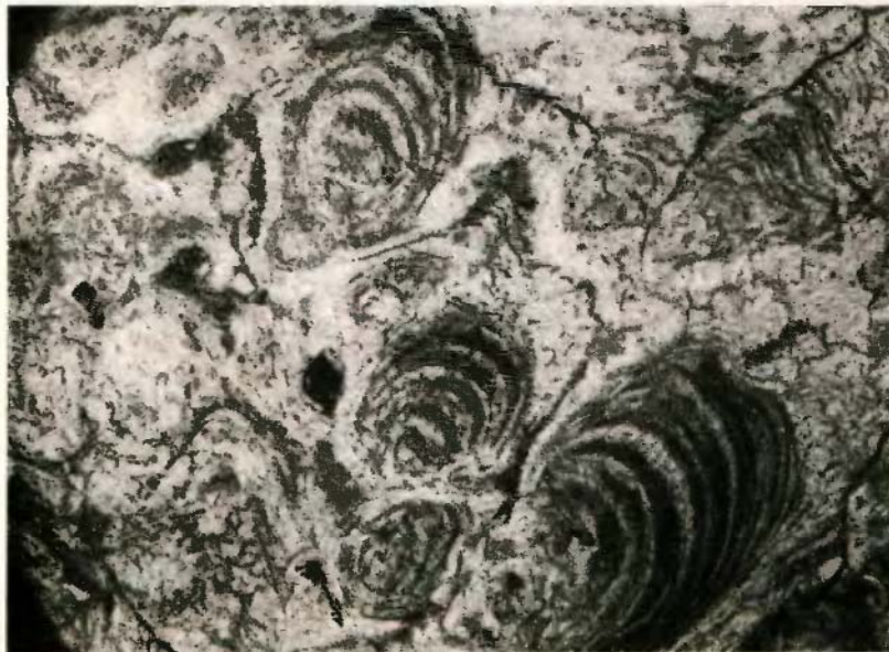
Фиг. 26 (1, 2). Структура гейзерита. Шлиф сделан \perp (1) и \parallel (2) наслоению.
