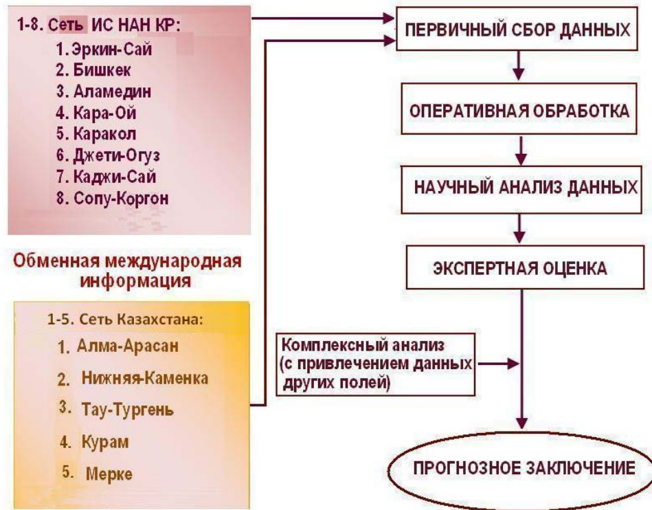
Рисунок 2. Структура функционирования международного гидрогеологического мониторинга Института сейсмологии НАН КР и Казахстана для сеймопрогностических целей.
