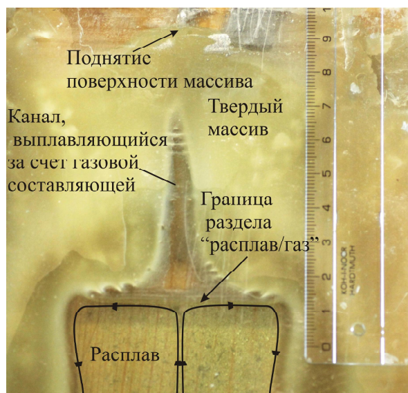
Рис. 3. Структура канала плюма перед прорывом плюма на поверхность при наличии газовой «подушки» над расплавом ( N = 9 \text{ Вт} , l = 12 \text{ мм} ). Схематично показаны свободно-конвективные течения в расплаве канала плюма / Fig. 3. Plume conduit structure before plume eruption with gas cushion above melt ( N = 9 \text{ W} , l = 12 \text{ mm} ). Free-convection flows in the melt of the plume conduit are shown schematically
