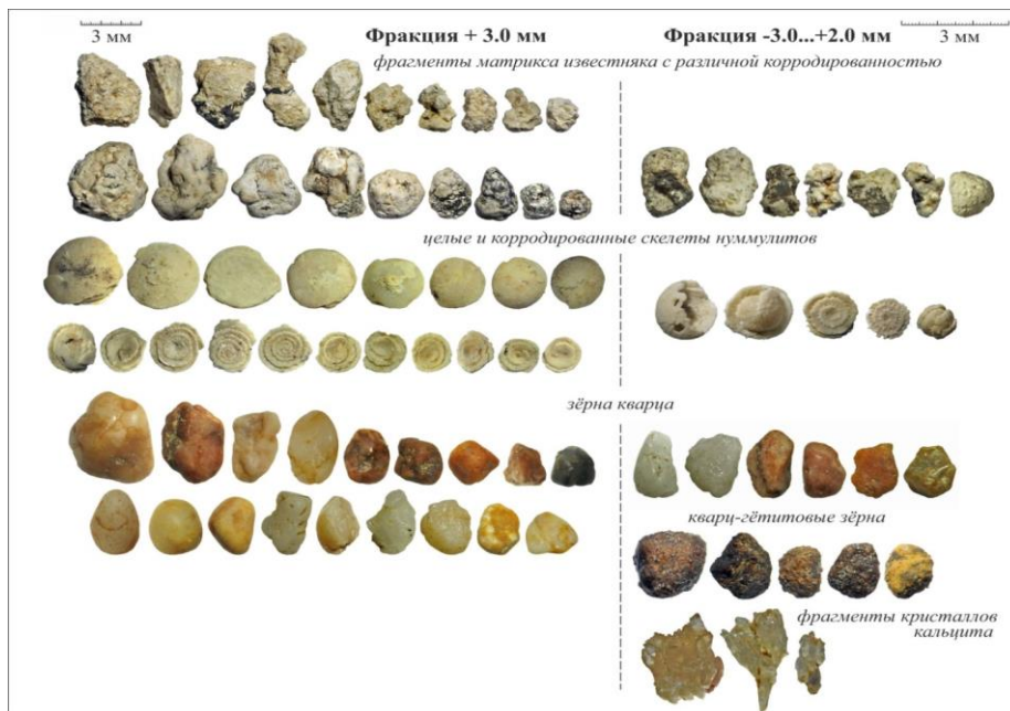
Рис 5. Морфология и вещественный состав зёрен из пробы Тавр-31 (фракции +3 мм и -3...+2 мм)
