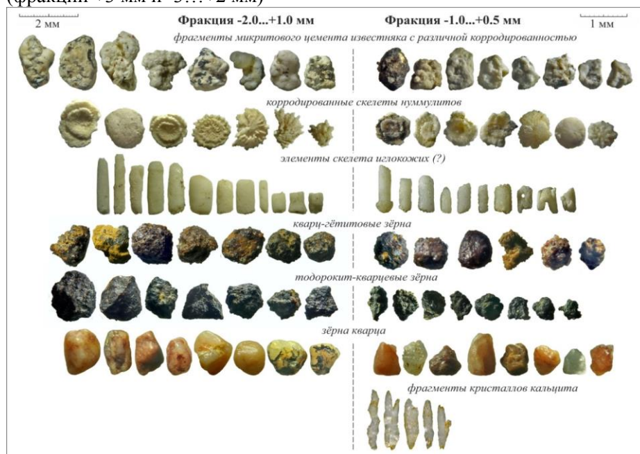
Рис 6. Морфология и вещественный состав зёрен из пробы Тавр-31 (фракции -2...+1 мм и -1...+0,5 мм)
