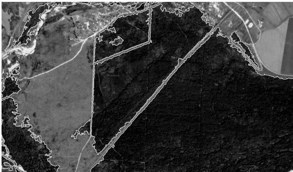
Рис. 2. Пример дешифрирования, тематической обработки и векторизации лесов Восточно-Казахстанской области на основе данных с КА «KazEOSat-1» с пространственным разрешением 1 метр
