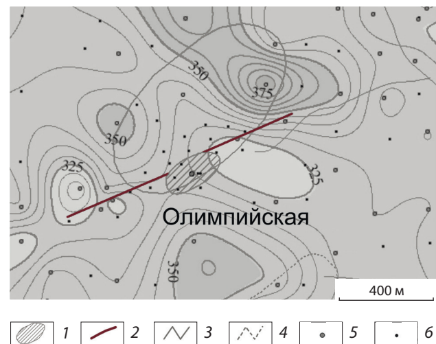
Рис. 6. ПОЛОЖЕНИЕ ИДЕНТИФИЦИРОВАННОГО ОРЕОЛА ИМК В РАЙОНЕ ТР. ОЛИМПЕЙСКАЯ В РЕКОНСТРУИРОВАННОМ ПАЛЕОРЕЛЬЕФЕ НА БАЗЕ ОСТАТОЧНЫХ МОЩНОСТЕЙ СИЛУРИЙСКИХ ОТЛОЖЕНИЙ (горизонталы проведены через 5 м):
