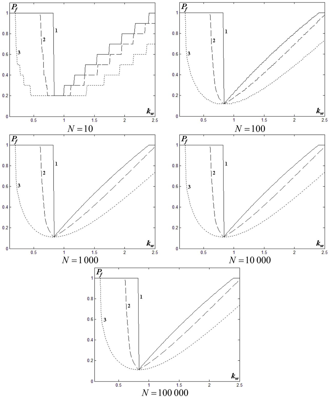
Рис. 3. Зависимость вероятности  $P_f$  разрушения горной породы околоскважинного пространства вертикальной скважины от нормированной величины  $k_w$  давления бурового раствора по методу ячеек ( $N$  – общее число комбинаций значений параметров среды): 1 – для критерия Мора-Кулона, 2 – для критерия Моджи-Кулона, 3 – для критерия Друкера-Прагера
