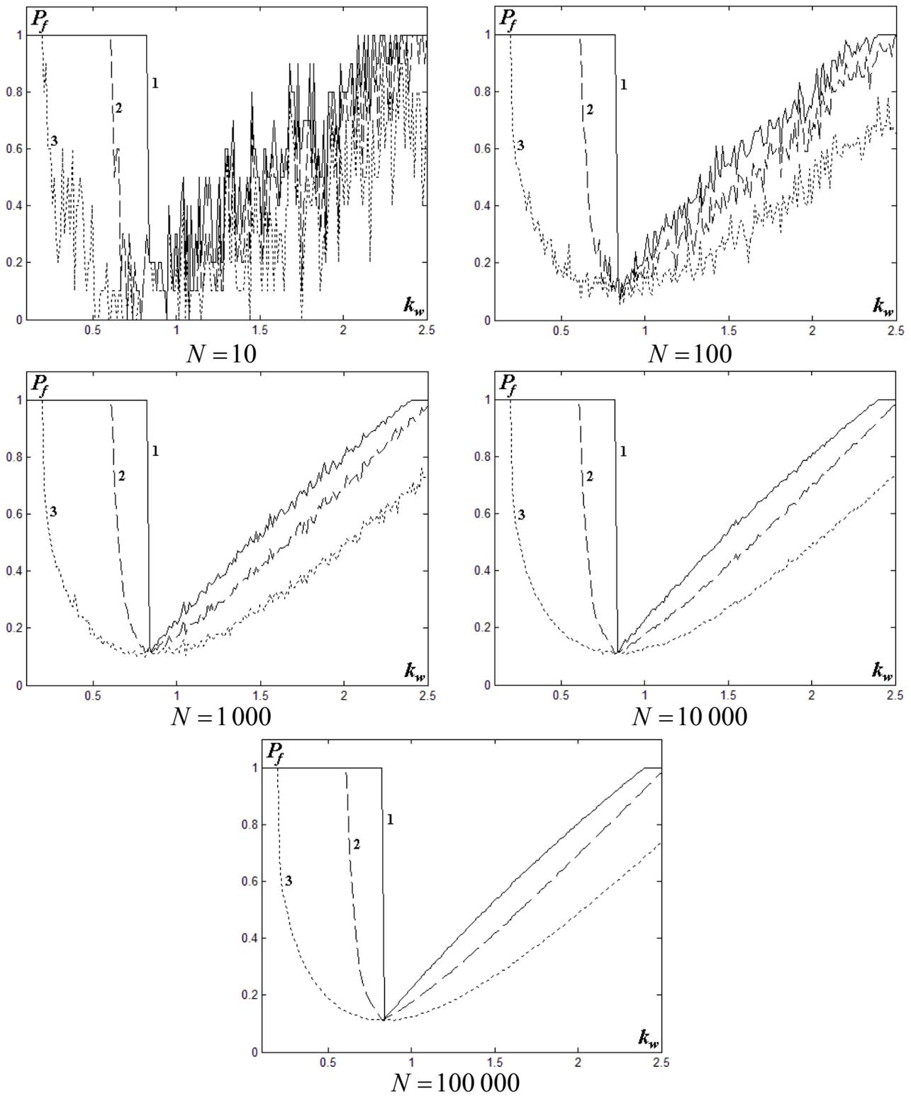
Рис. 2. Зависимость вероятности  $P_f$  разрушения горной породы околоскважинного пространства вертикальной скважины от нормированной величины  $k_w$  давления бурового раствора по методу Монте-Карло ( $N$  – общее число комбинаций значений параметров среды): 1 – для критерия Мора-Кулона, 2 – для критерия Моджи-Кулона, 3 – для критерия Друкера-Прагера
