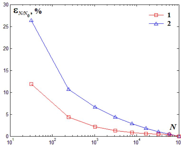
Рис. 5. Зависимость среднего относительного отклонения  $\varepsilon_{N/N_0}$  от числа  $N$  комбинаций значений параметров среды (неопределенность по пяти параметрам): 1 – для метода Монте-Карло, 2 – для метода ячеек
