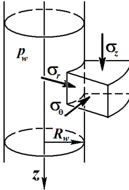
Рис. 1. Главные напряжения вокруг вертикальной скважины
