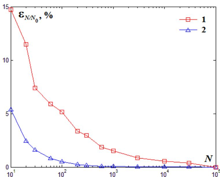
Рис. 4. Зависимость среднего относительного отклонения  $\varepsilon_{N/N_0}$  от числа  $N$  комбинаций значений параметров среды (неопределенность по коэффициенту Пуассона): 1 – для метода Монте-Карло, 2 – для метода ячеек
