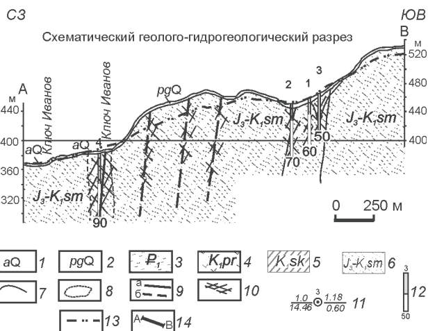
Рис. 2. Геолого-гидрогеологическая карта и схематический геолого-гидрогеологический разрез Фадеевского месторождения углекислых минеральных вод.
