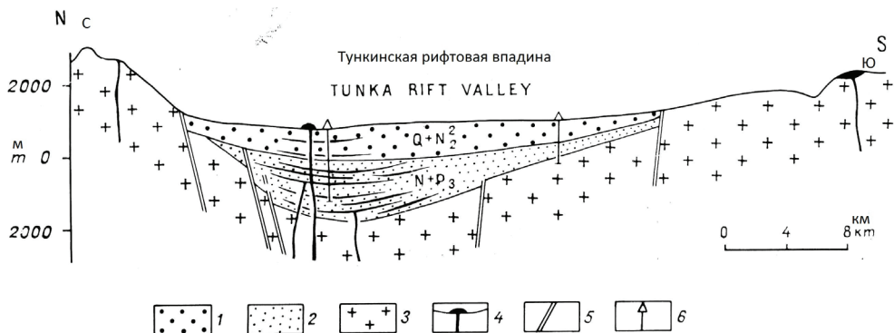
Рис. 2.3. Геологический разрез Тункинской впадины (по [Logatchev, 1993]).
