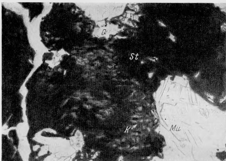
Рис. 6. Реликты касситерита ( K ) в станнине ( St ); Mu — мусковит, Q — кварц. \times 20 , без анализатора.
