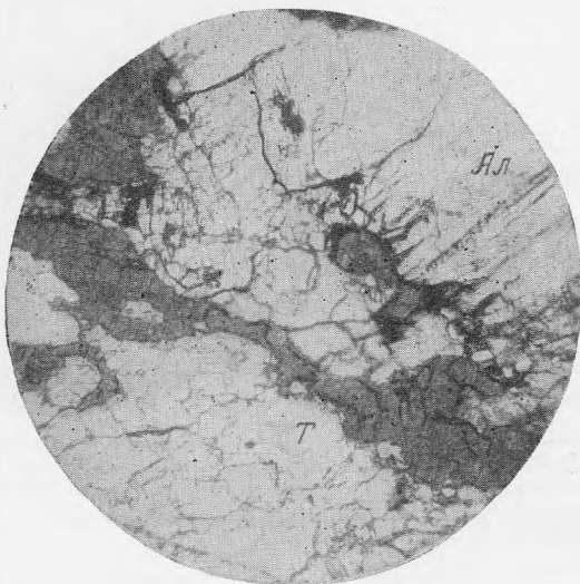
Рис. 6. Реакционная кайма арроядита на границе трифилина (Т) и альбита (Ал). Ув. 8; без анализатора.
