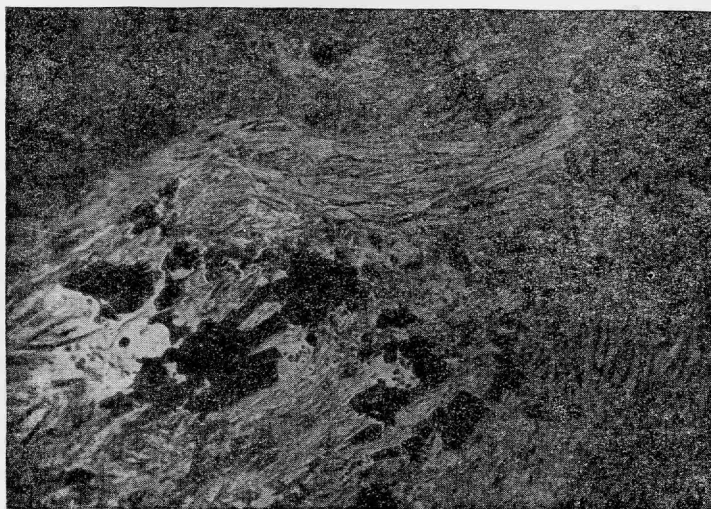
Рис. 3. Аналиф конкреции: делафоссит (светлый), гидроакрит (черный). Ув. 250.
