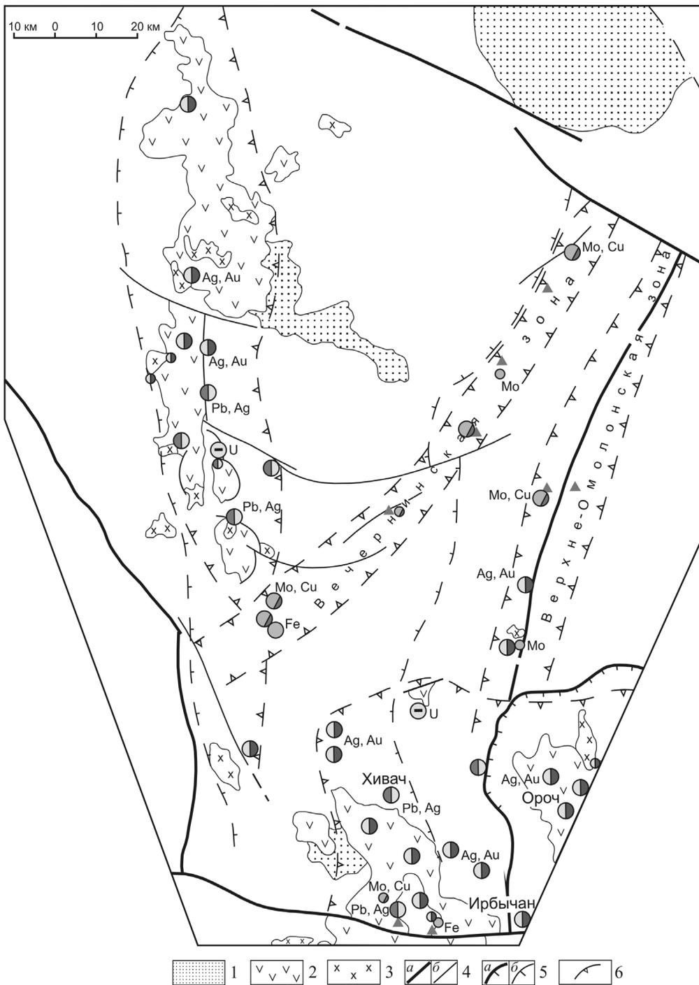
Рис. 10.1. Рудоносность позднего мезозоя: 1 – осадочные породы; 2 – эффузивы  $K_{1-2}$ ; 3 – интрузивы  $K_2$ ; 4 – разломы: главные (а), второстепенные (б); 5 – надвижки главные (а) и второстепенные (б); 6 – контуры металлогенических зон
