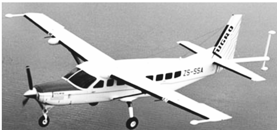
Рис. Жесткая установка четырехдатчиковой системы на одномоторном самолете Цессна 208 Караван (фирма Fugro Airborne surveys, США). Расстояние между датчиками, установленными за хвостом самолета, 2 м; между датчиками на концах крыльев 16 м.
