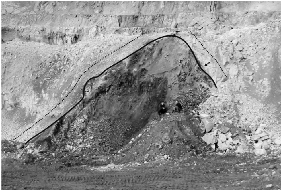
Рис. 4. Обеленные породы на контакте с рудным телом на горизонте 140, 0 м между разведочными линиями 5–6. Высота борта 10 м. Сплошной линией показана граница зоны контакта с рудным телом; стрелкой показана область развития минеральной ассоциации алунит-каолинит-серицит-пирит-кварц; точками показана примерная граница развития ассоциации каолинит-серицит-хлорит-кварц (примерно 1 м от границы с рудным телом)
