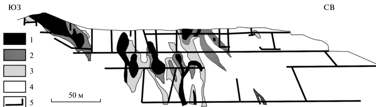
Фиг. 6. Распределение золота в продольном разрезе наиболее продуктивной части зоны родингитов (по фондовым материалам Н.И. Бородаевского). 1 – очень богатые руды с кустовым распределением золота; 2 – богатые руды; 3 – руды со средним содержанием; 4 – бедные и очень бедные руды; 5 – горные выработки.
