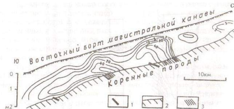
Рис. 30. Характер выраженности слабоэродированного золотосульфидного оруденения сухоложского типа в шлиховых ореолах. Месторождение Сухой Лог. Промышленное оруденение не выходит на поверхность.
