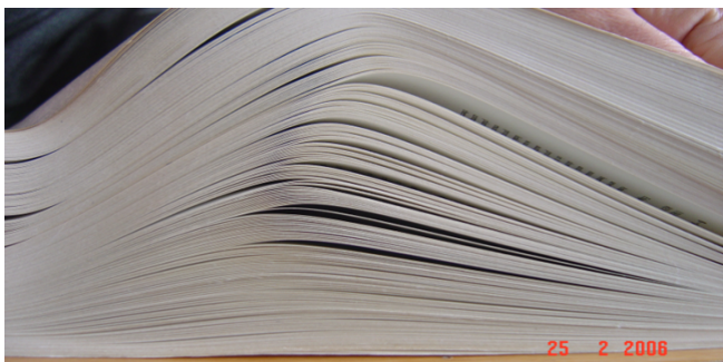
Рис.6 Разрушения путем раслаивания (размочаливания)
