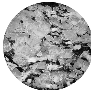
Эвдиалитовая руда, содержащая идиоморфный эвдиалит (фото в проходящем свете, \times 4 )
