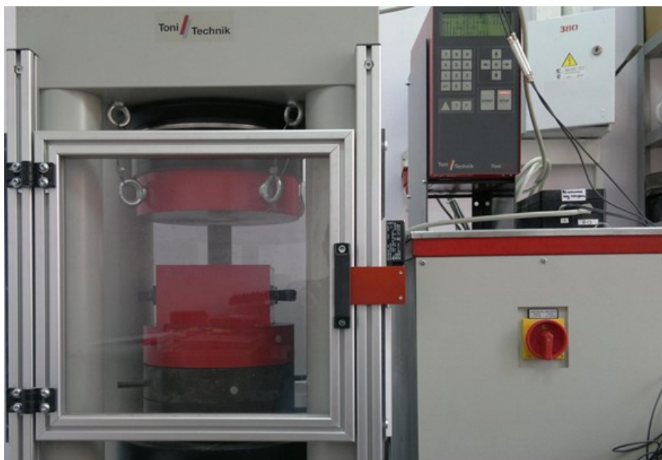
Рис. 2 – Размещение образца между плитами испытательной машины ToniРАСТП-2091
