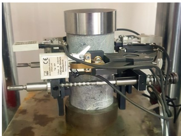
Рис. 4 – Устройство с датчиками продольной и поперечной деформации для определения упругих параметров образцов диаметром 60 – 70 мм на испытательной машине ТопiРАСТII
