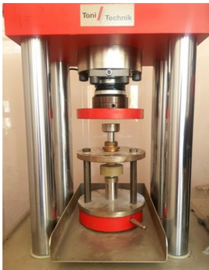
Рис. 3 – Размещение образца между сферическими инденторами испытательной машины ToniNORM-2020
