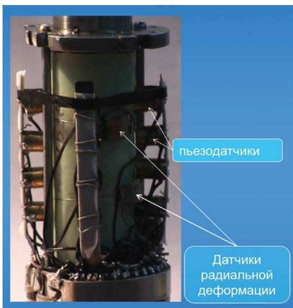
Рис. 6.4. Ячейка для размещения образца пресса INOVA. Содержит систему акустических и тензометрических датчиков, установленных на образец. Разъёмы для подключения к измерительной аппаратуре смонтированы в нижнем пуансоне ячейки.
