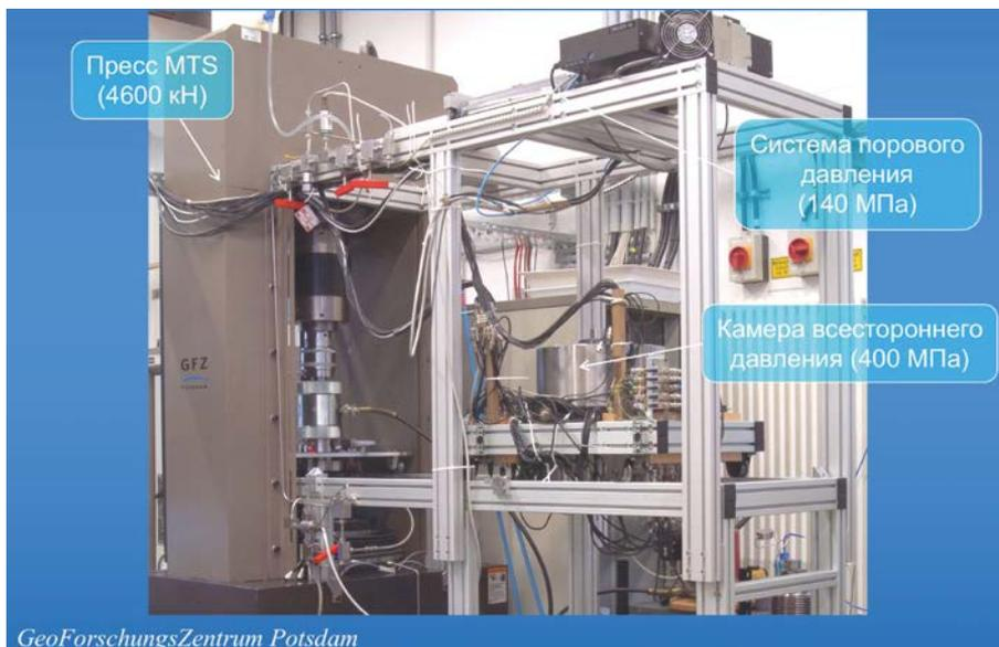
Рис. 6.1. Нагружающая машина в лаборатории геомеханики и реологии (GFZ Potsdam), 2009 г. Мощная стальная станина с двумя опорными колоннами, подвижный стол для монтажа образца в камеру всестороннего давления, система контроля порового давления, гибкие гидравлические шланги и электроводы.
