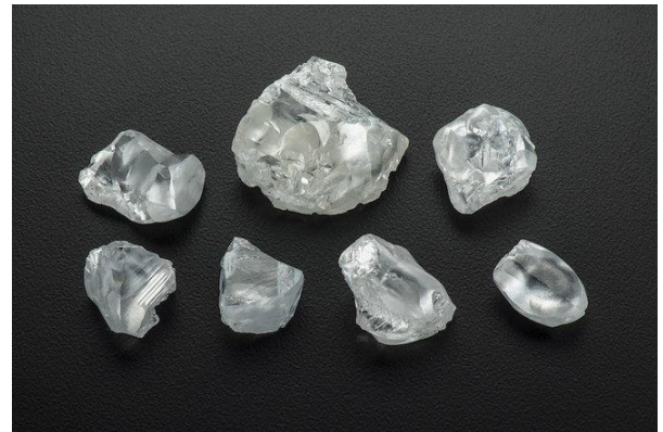
Рис. 1.14. Типичный облик крупных кристаллов сублитосферных “CLIPPIR diamonds” (фото внизу, GIA) и характерный для них минеральный состав включений Fe-Ni-C-S расплава (фото справа, по данным работы Smith et al., 2016).
