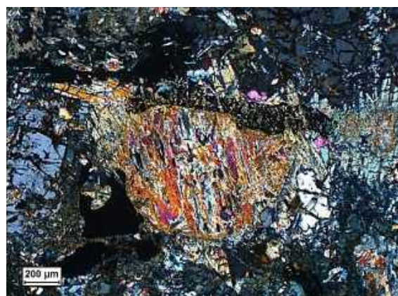
Рисунок 10 – Структуры силикатных агрегатов: замещения плагиоклаза сосюритом (а); ситовидного строения – псевдоморфоза амфибола по пироксену (б). Проходящий свет, николи параллельны (а) и скрещены (б)
