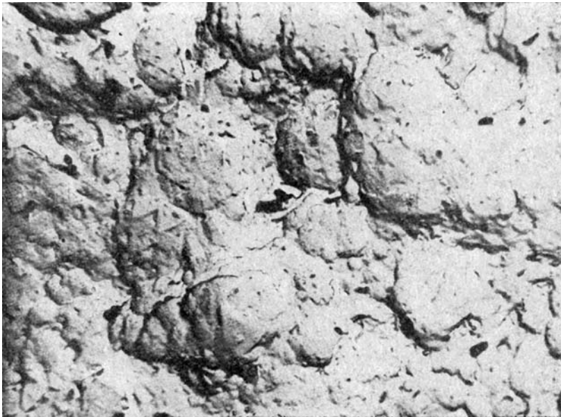
Рис. 109. Структура поверхности излома хромита из нодулярной руды. Начальная стадия развития ограненных субиндивидов по колломорфному агрегату. Краевая часть нодуля. Массив Рай-Из, р. Енга-Ю, обр. 5026. Угольная реплика, \times 24\ 000 .
