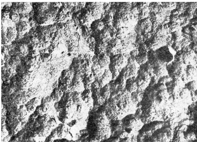
Рис. 107. Структура поверхности излома хромита из нодулярной руды. Краевая часть нодуля. Массив Рай-Из, р. Енга-Ю, обр. 5026. Угольная реплика, \times 30\ 000 .
