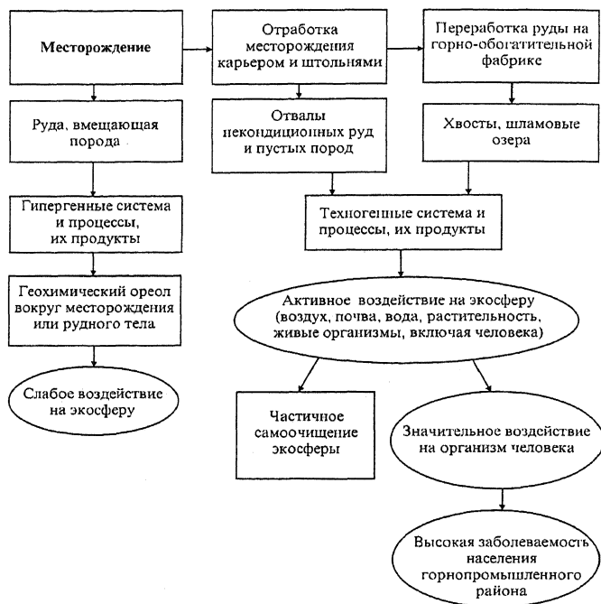
Рис. 6. Схема гипергенных и техногенных процессов на оловорудных месторождениях Дальнего Востока
