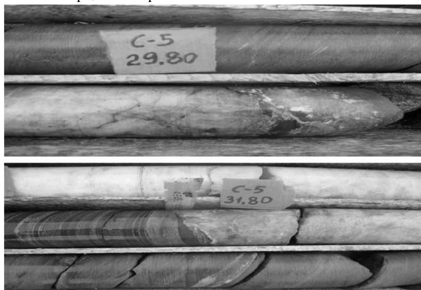
Рис. 3. Внутреннее строение золотиносных жил и прожилков (диаметр керна 61 мм)
