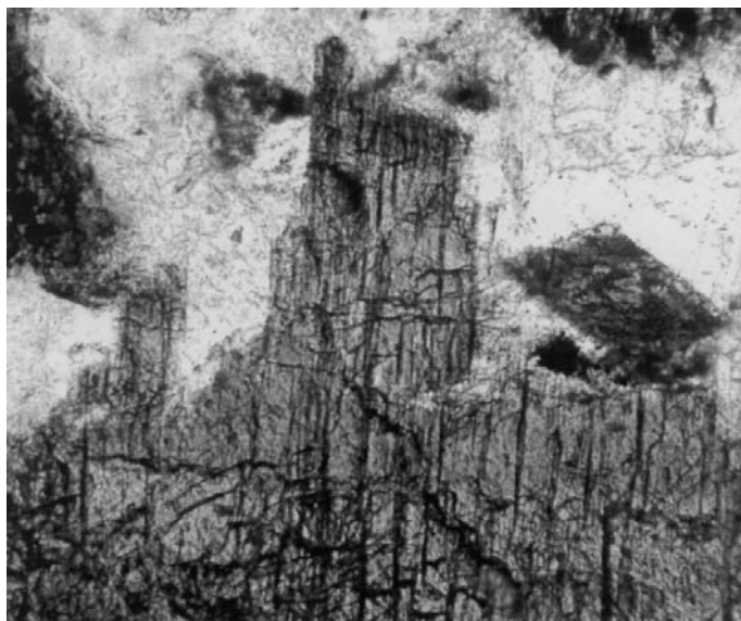
Рис. 4. Кайма глаукофана вокруг керсутита на контакте с кальцитом (белое). Шлиф. Ник. ||.
