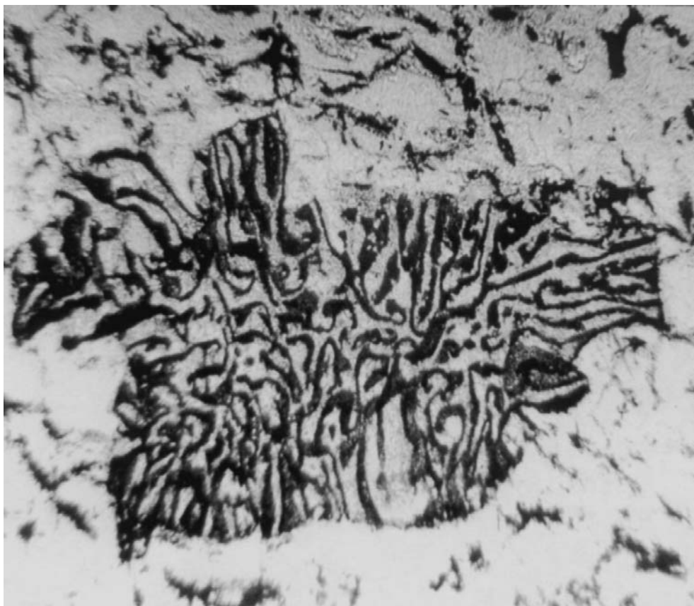
Рис. 2. Морфология выделений хромшпинелидов в гипербазитовых включениях. Шлиф. Ник.||.
