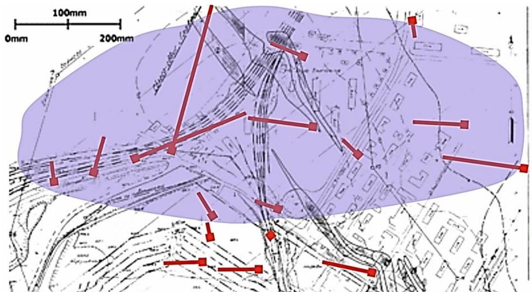
Рис. 2 – Векторы встречных геодинамических движений в районе железнодорожной станции на Высокогорском ГОКе в период с 2008 по 2009 г.
